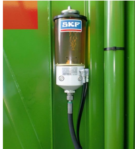
Afb.: Smeerinstallatie van de freeswerk-aandrijfkettingen
