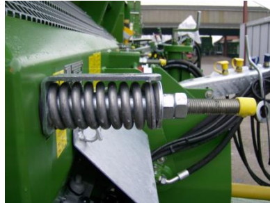
Afb.: Instellen van de transportbodemuketting (buiten)
